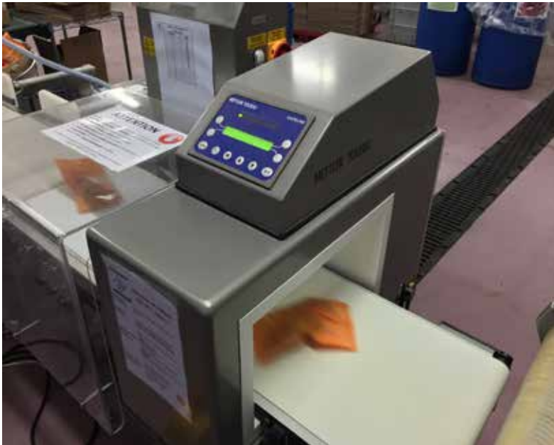
ณ จุดควบคุมวิกฤติ (CCP) ในสายการผลิต ระบบจะตรวจสอบแพ็คเกจบรรจุทั้งหมดเพื่อมองหาโลหะปลอมปน ช่วยดูแลให้ความปลอดภัยของผลิตภัณฑ์สอดคล้องตามข้อกำหนด IFS
