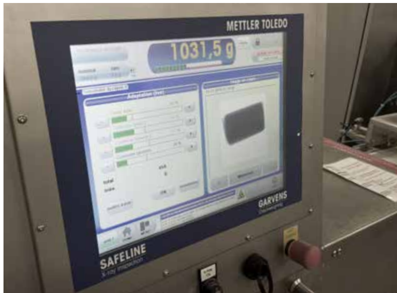
อินเตอร์เฟซผู้ใช้ของซอฟต์แวร์ของระบบทำงานร่วมกันช่วยแสดงทั้งผลลัพธ์ของการชั่งน้ำหนักและการเอ็กซ์เรย์ตรวจสอบสิ่งปลอมปน
