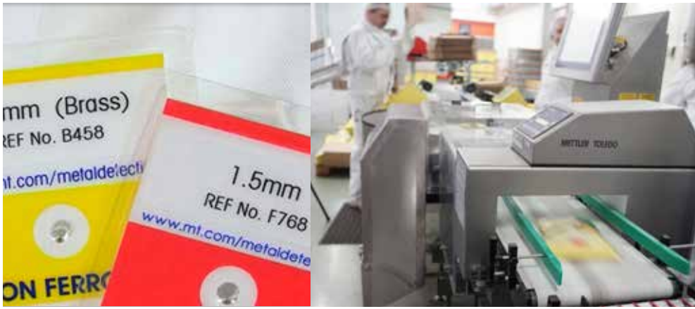
เครื่องตรวจจับโลหะจะถูกทดสอบในทุก ๆ 8 ชั่วโมงของการผลิต
